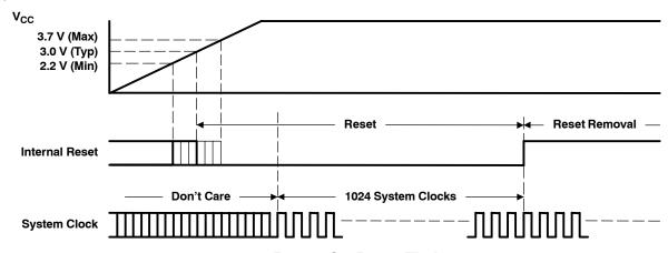
Figure 20. Power-On Reset Timing
